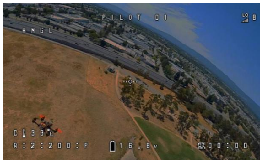
Рисунок 3. Рекомендованная настройка OSD дрона
